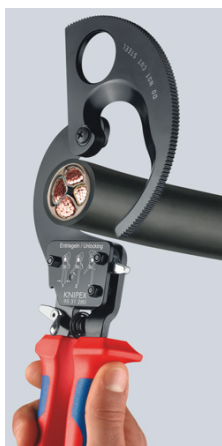
95 31 280: Увеличенный растров: максимальный Ø 52 мм/380 мм 2
